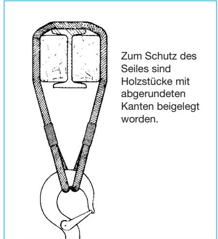
*Bild 7-8: Schwungrad, gehoben mit zwei SpanSet-Power-Hebebändern B 2000 einfach umgelegt*
