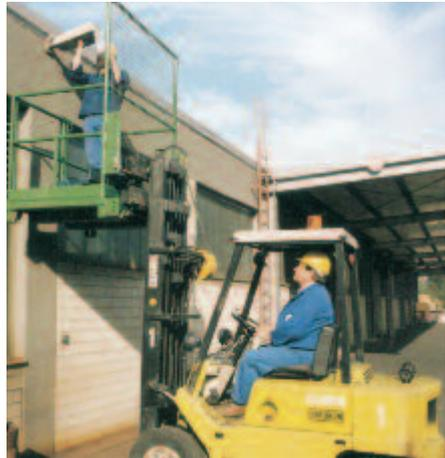
*Bild 2-7: Arbeitsbühne mit Sicherung gegen Abrutschen*
