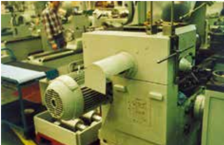
Bild 2-24: Spänefangereinrichtung an einer Drehmaschinenhohlwelle
