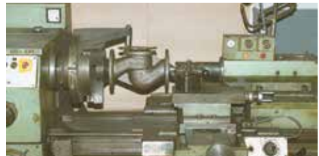
Bild 9-1: Drehmaschine mit sicherheitswidriger Spanneinrichtung, Beispiel 1
