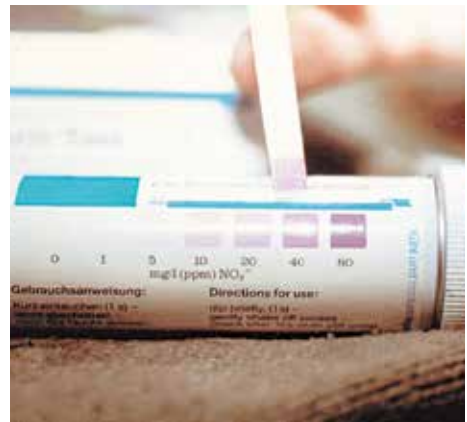
Bild 4-5: Prüfung des Nitritgehaltes durch Farbvergleich
