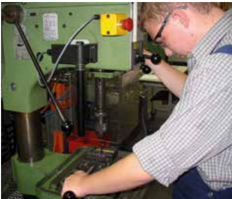
Bild 2-23: Bewegliche Verdeckung an einer Bohrmaschine
