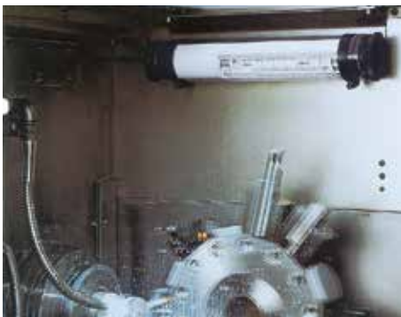
Bild 5-3: Maschinenschutzrohrleuchten in Werkzeugmaschinen
