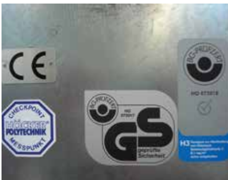
Bild 1-4: Typenschild an einer Maschine mit CE-Kennzeichnung; zusätzlich GS-, BG-PRÜFZERT-Zeichen nach freiwilliger Baumusterprüfung
