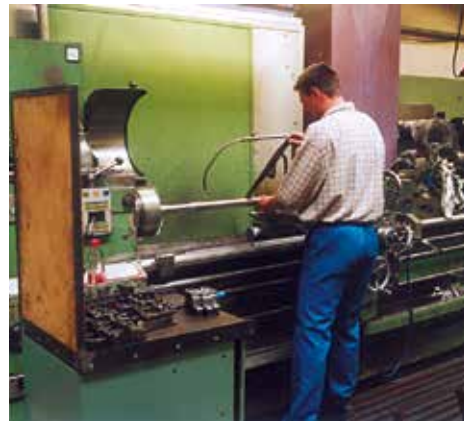
Bild 2-21: Gefahr des Erfasstwerdens an glatten, rundlaufenden Wellen
