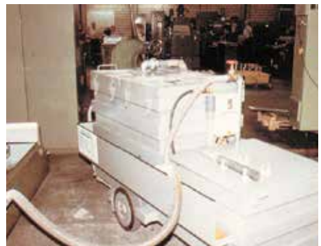
Bild 4-8: Wechseleinrichtung für Kühlschmierstoffe
