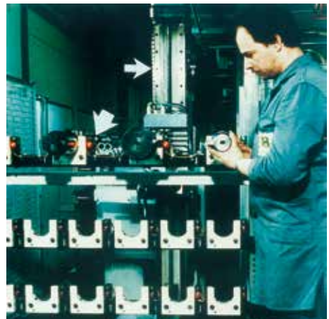
Bild 2-41: Räumliche Trennung in Werkzeugwechselstation durch Werkzeugregal
