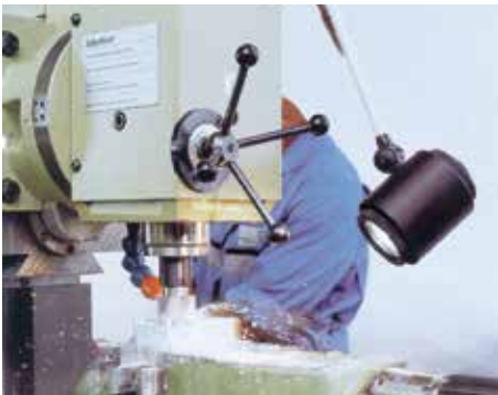
Bild 5-2: Halogenmaschinenleuchte IP 65 bei mech. Beanspruchung und Einsatz von KSS
