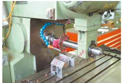
Bild 9-8: Haut- und Kleidungsreste am ungeschützten Scheibenfräser
