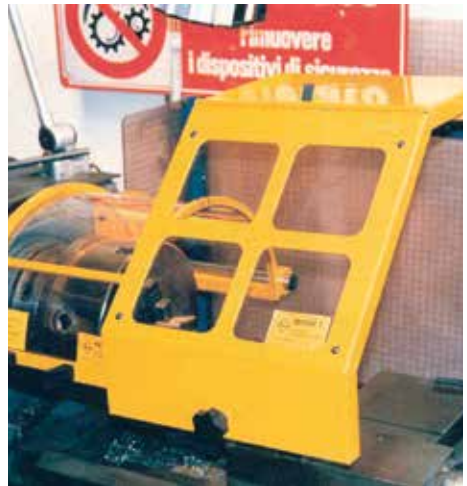
Bild 1-10: Futterschutzhaube an einer konventionellen Drehmaschine, Beispiel 2
