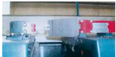
Bild 9-7: Manipulation des Positionsschalters
