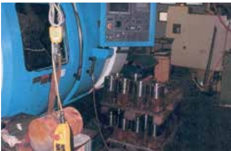
Bild 9-9: Unfallmaschine und Werkstückaufprall (Fußboden)
