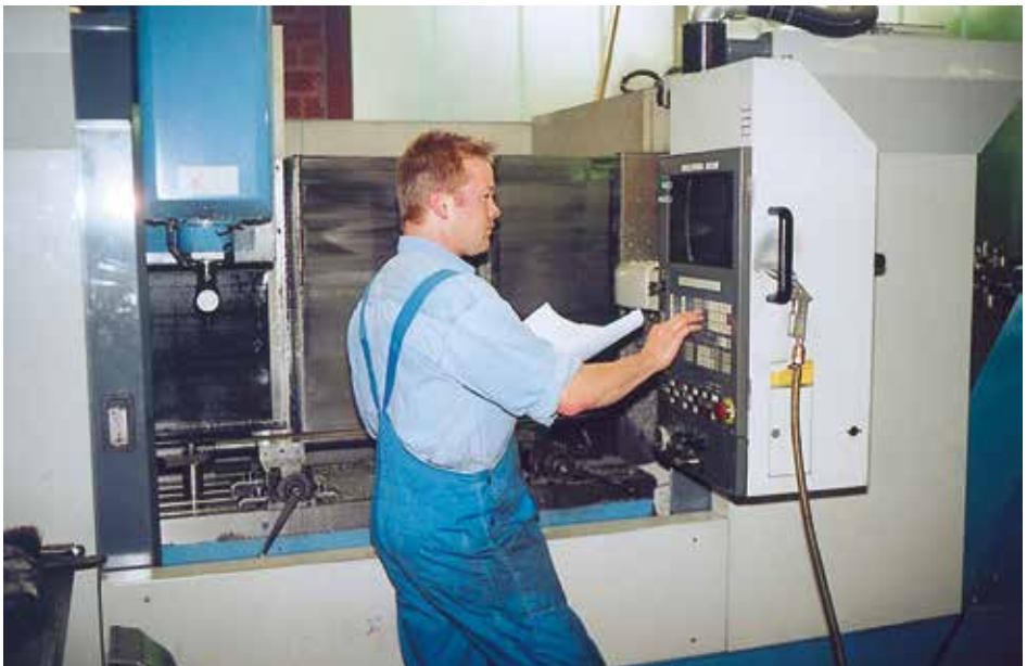
Bild 6-3: Dateneingabe nach Betriebsanleitung
