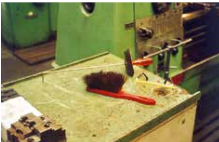
Bild 2-26: Schutzausrüstung am Drehmaschinenarbeitsplatz
