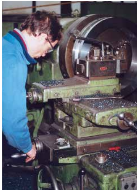
Bild 2-4: Gefährdung durch wegfliegende Späne beim Drehen
