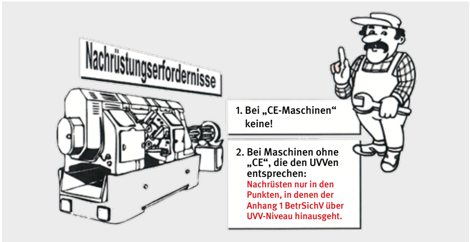
Bild 1-8: Nachrüstungserfordernisse an Maschinen
