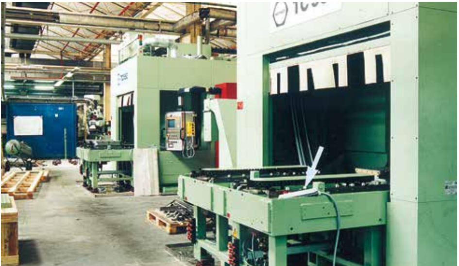
Bild 2-13: Handsteuerung für das Erproben
