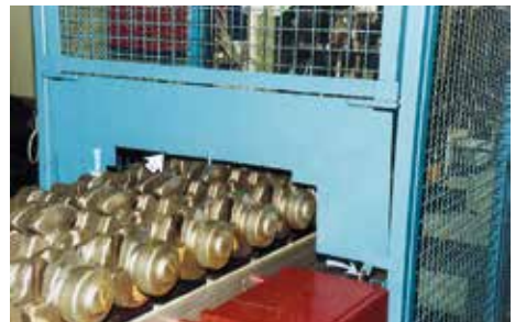
Bild 2-30: Einlaufschutz am formschlüssigen Transportsystem mit hoher Zugkraft
