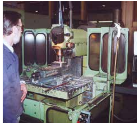
Bild 2-2: Gefährdungen durch Kühlschmierstoffe und Maschinenbewegungen
