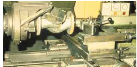
Bild 9-2: Drehmaschine mit sicherheitswidriger Spanneinrichtung, Beispiel 2
