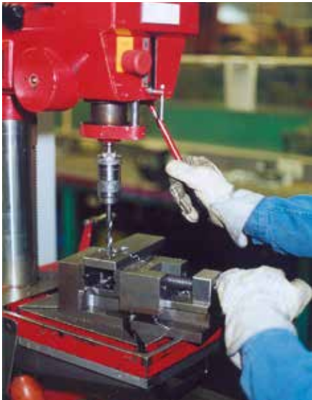
Bild 7-2: Verboten: Bohren mit Handschuhen und ohne Sicherung gegen Herumschlagen (Bild nachgestellt)
