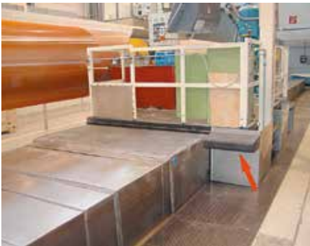
Bild 2-48: Bedienstand (Support) einer Großdrehmaschine. Die Längsbewegung ist im Überhangbereich durch Schuttpuffer/Bumper zu beiden Seiten gesichert
