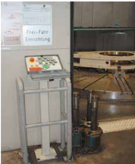
Bild 2-39: Freifahreinrichtung mit sinnfälliger Kennzeichnung der Achsbewegungen über eigene Tiptaster
