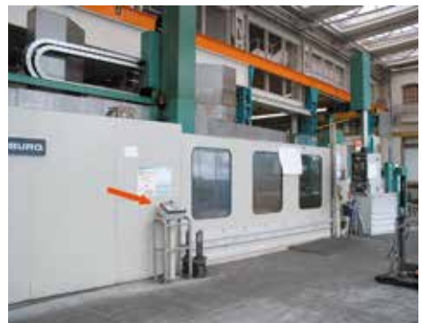
Bild 2-38: Große eingehauste Vertikal-Drehmaschine mit Freifahrereinrichtung
