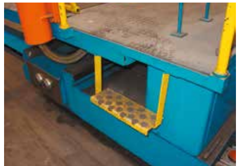
Bild 2-55: Sicherer Aufstieg auf Bedienstand einer Horizontal-Drehmaschine
