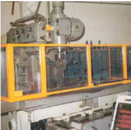
Bild 1-12: Verdeckung an einer konventionellen Fräsmaschine, Beispiel 1
