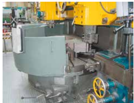
Bild 2-50: Vertikal-Drehmaschine mit trennender Schutzeinrichtung (Schiebemechanismus)
