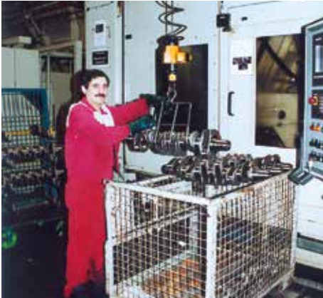
Bild 5-4: Kurbelwellenbeladung mittels Hebehilfe
