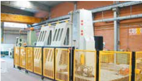
Bild 2-52: Bearbeitungszentrum mit Umzäunung
