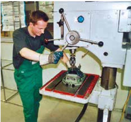
Bild 2-22: Verbotswidriges Arbeiten mit Handschuhen (nachgestellt)
