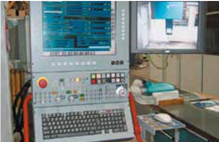
Bild 2-33: Hauptbedienfeld der CNC-Steuerung eines großen Bearbeitungszentrums mit abschließbarem Betriebsartenwahlschalter
