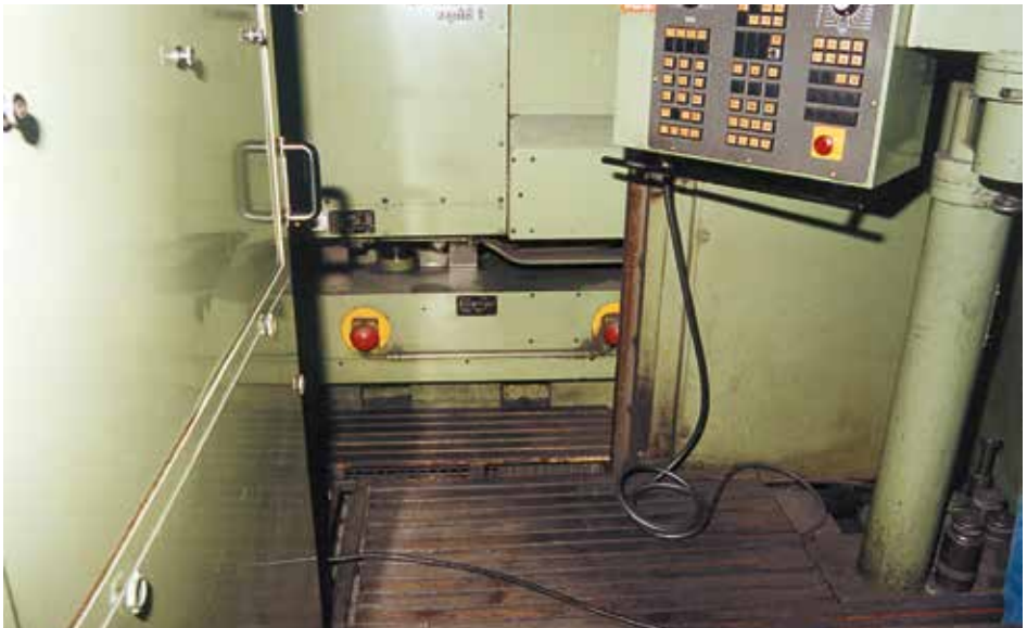
Bild 2-16: Zusätzliche Not-Aus-Schalter im Fußbereich an einem Bearbeitungszentrum
