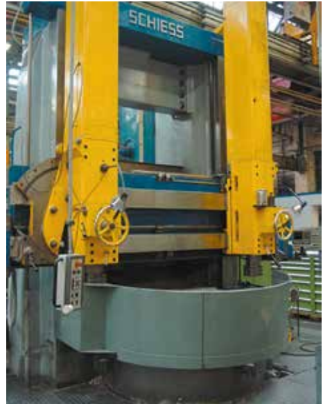
Bild 2-49: Vertikal-Drehmaschine (ältere Bauart) mit trennender Schutzeinrichtung
