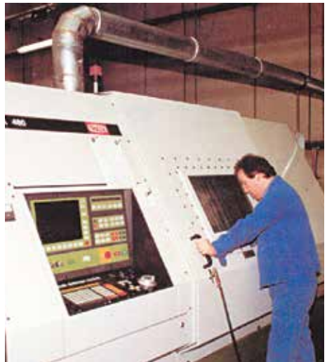
Bild 4-1: Absaugung an einer CNC-Drehmaschine
