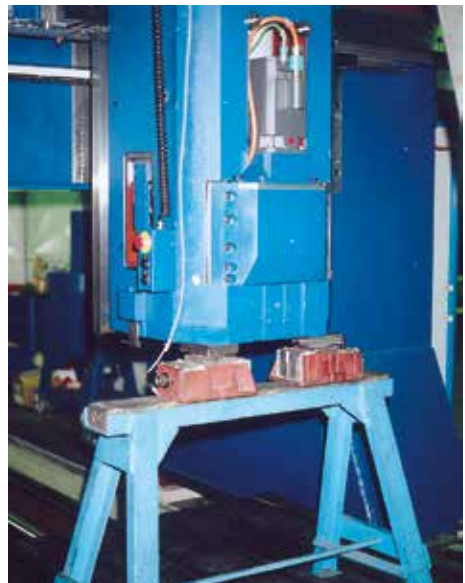
Bild 6-2: Vertikale Abstützung eines in der Montage befindlichen Werkzeugschlittens
