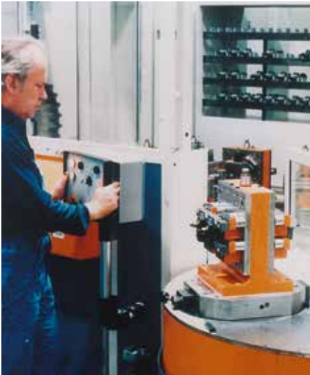
Bild 2-32: Auslösung eines Materialtransportes durch ortsbindende Zweihandbedienung
