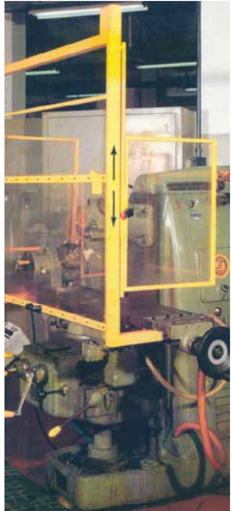
Bild 1-13: Verdeckung an einer konventionellen Fräsmaschine, Beispiel 2
