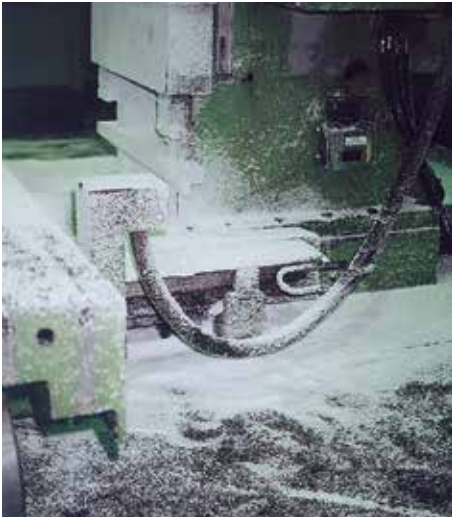
Bild 2-3: Gefährdung durch Ausrutschen
