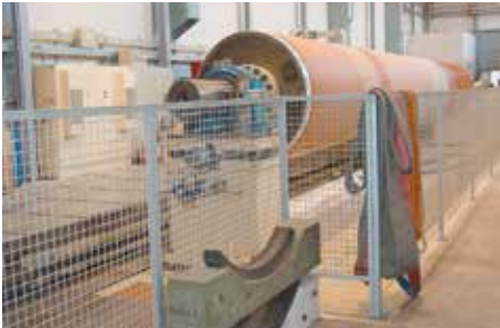
Bild 2-51: Horizontal-Drehmaschine mit rückwärtiger Umzäunung (mindestens 1,4 m hoch)
