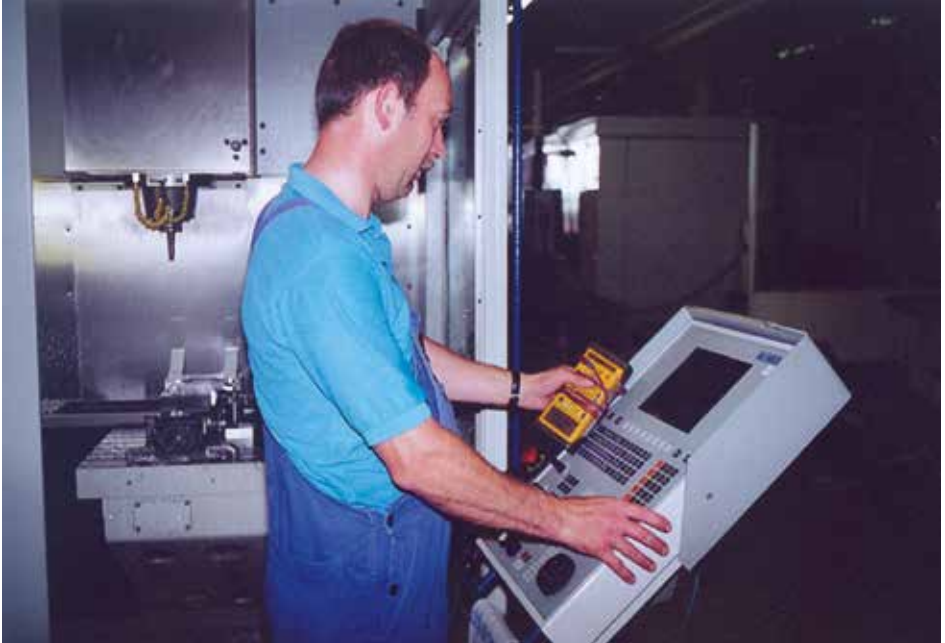
Bild 2-56: Das Fehlerprotokoll informiert über die Störungsursache
