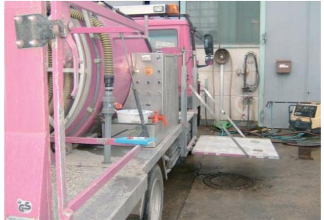
Bild 7: Seitliche Ladebordwand, die manuell auf- und zuklappt und kraftbetätigt nach oben und unten fährt
