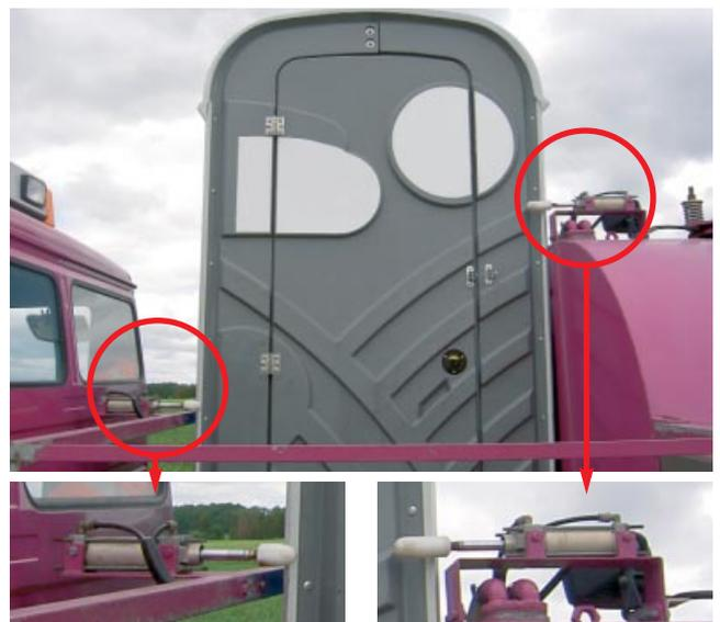
Bild 9: Druckluftbolzen zum Fixieren der Miettoiletten auf der Ladefläche
