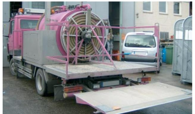
Bild 8: Fahrzeug mit fest angebrachtem Metallgeländer als Ladungssicherung
