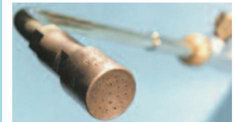
Bild 2-13: Saugprobe am Injektorbrenner
