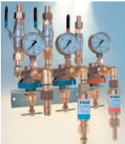
Einen Sonderfall der Sicherheitseinrichtungen stellt die Gebrauchsstellen-vorlage ATEX dar, die jedoch nur für den Einsatz mit Injektorbrennern geeignet ist. Sie ist eine Kombination aus Sicherheitseinrichtung und Leckgas-sicherung.
