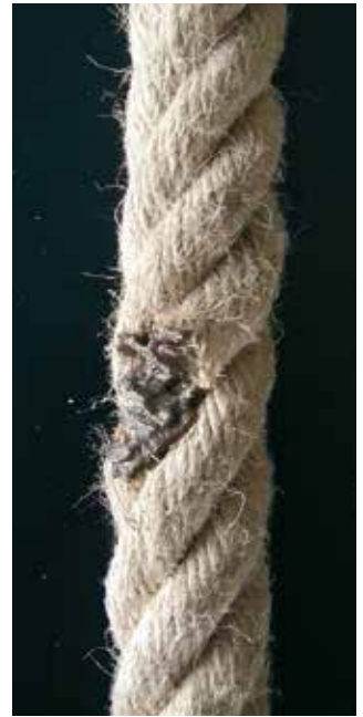
Bild 23-9: Wärmeeinfluss hat eine Litze zerstört
