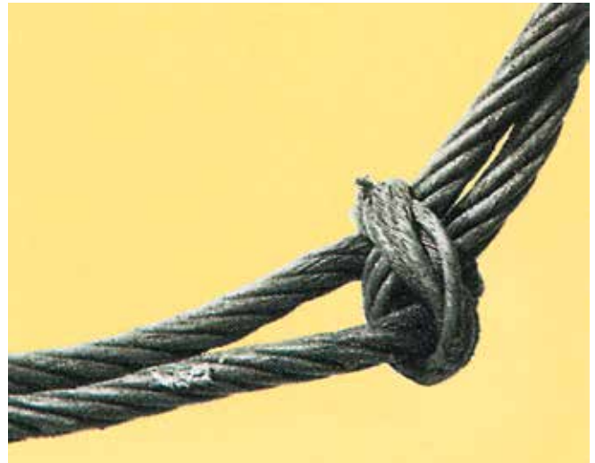
Bild 9-2: Unzulässiger Knoten zerstört den Seilverbund
