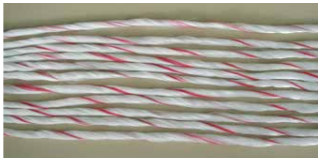
Bild 23-19: Die Einlage einer Rundschlinge besteht meist aus einer einzelnen Kardeele, die mindestens 11-mal umläuft. Wird diese nur einmal durchgeschnitten, ist der innere Verbund der Rundschlinge durch Reibung nicht mehr gegeben!
