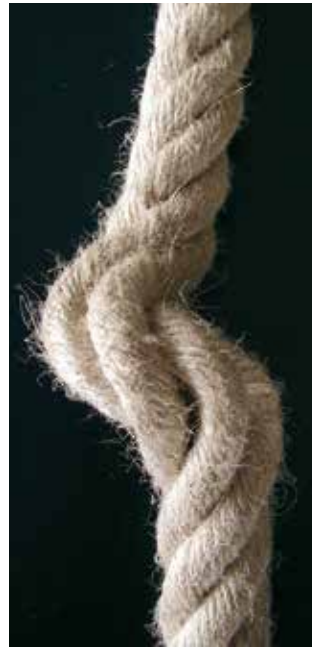
Bild 23-8: Durch Kante zerstörter Litzenverbund
