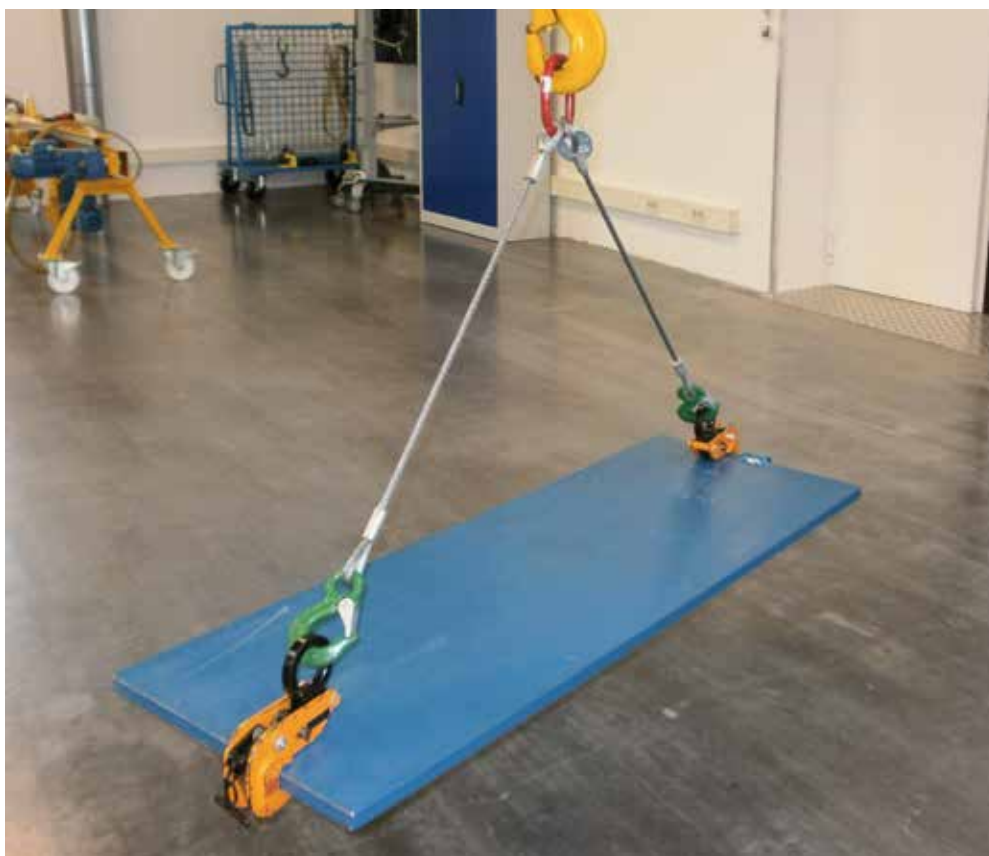
Bild 13-1: Blech horizontal sicher transportiert
