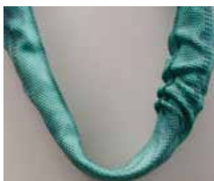
Bild 23-17: Verformung durch Wärme
