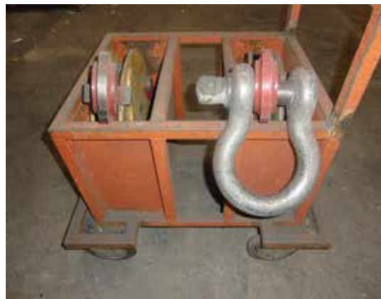
Bild 24-2: Abgestellte, gegen Umfallen gesicherte Lastaufnahmemittel
