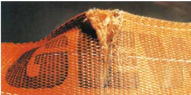
Bild 23-14: Durch scharfkantige Last eingeschnittenes Hebheband
