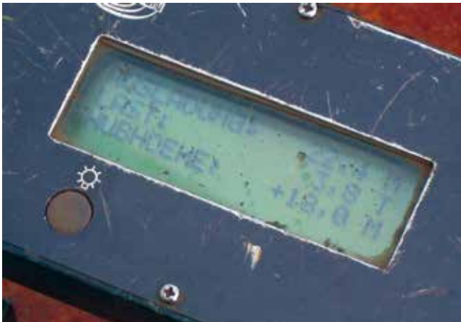
Bild 5-3: Steuerbinne mit digitaler Lastanzeige
