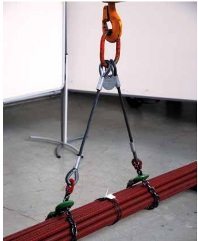
Bild 6-1: Kombination Seil/Kette zur Schonung der Drahtseile
