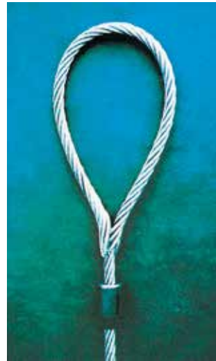
Bild 9-7: Die beiden Enden sind gegeneinander verseilt
