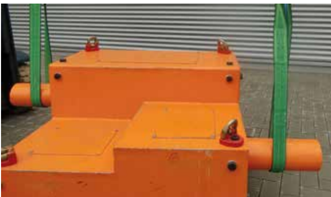
Bild 6-2: Hebebänder sind oberflächenschonend
