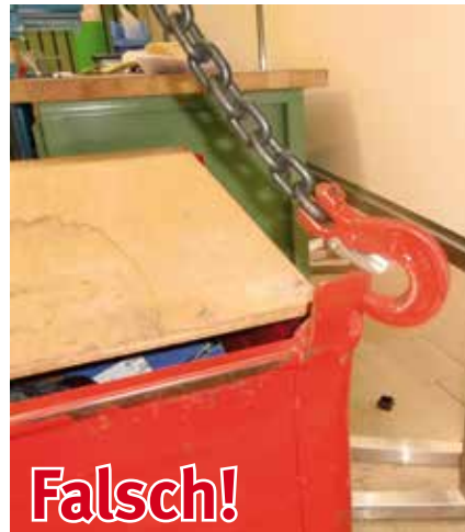
Bild 16-4: Haken rutschen bei Schlaffketten aus den Ösen
