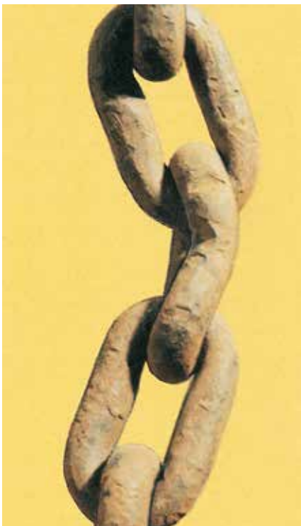
Bild 23-10: Kette mit verbogenem und eingekerbtem Kettenglied
