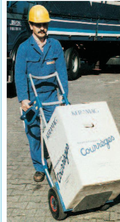
Wenn der Schwerpunkt der Last auf einer Stechkarre genau über der Achse liegt, ist die Haltekraft an den Griffen am geringsten. Das „Halten des Schwerpunktes über der Achse“ ist umso schwieriger, je höher der Schwerpunkt liegt.
