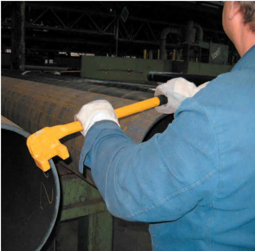
Wichtig ist, dass unmittelbar nach Überschreiten des Kipp-Punktes bzw. bei Beginn der selbstständigen Bewegung das C-förmige Maul vom Profil abgezogen wird, sonst können schwere Zerrungen bzw. Schlagverletzungen durch das schlagende Kanteisen die Folge sein.
