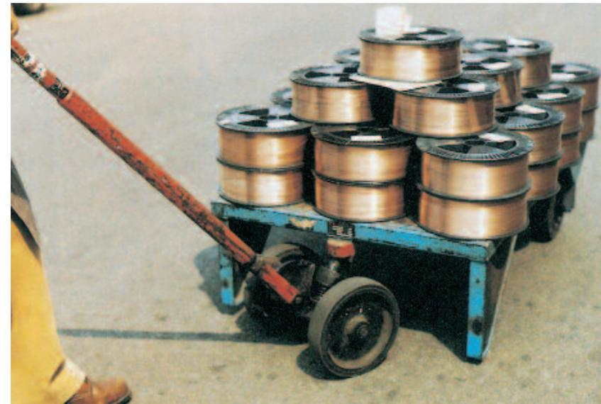
beispielsweise während des Beladens, gesichert. Zum Verfahren der Rollpritsche muss die Seite mit den Stützen angehoben werden. Das geschieht üblicherweise mit einem **Heberoller**.
