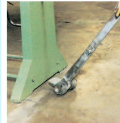
Der **Rohrschlüssel** kann zum Rollen von Rohren und Wenden von Profilstählen verwendet werden. Der Vorteil zum bekannten Kanteisen besteht in dem um 180° schwenkbaren vorderen
