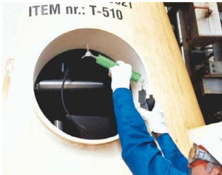
Abb. 20 Probenahme mittels Gassammelrohr
