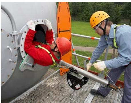
Abb. 26 Seiteneinstieg mittels spezieller Halterung des Rettungshubgerätes
