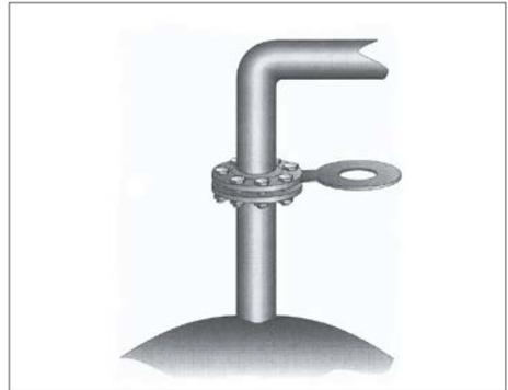
Abb. 18 Abtrennen mittels Steckscheibe
