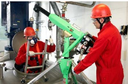
Abb. 22 Rettungswinde mit integrierter Absturz-sicherung
