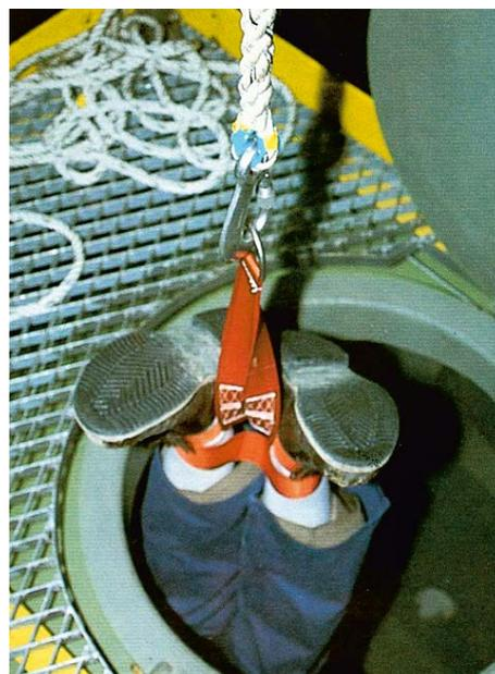
Abb. 28 Rettungsschleufe (besonders geeignet zum schnellen Retten)
