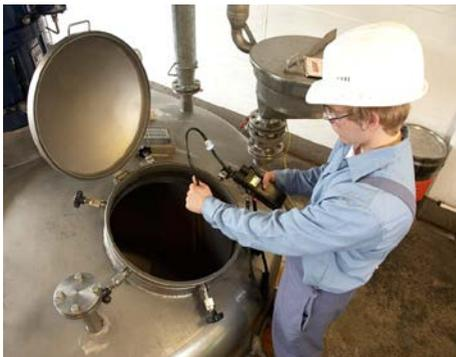
Abb. 19 Probenahme mittels Gasmessgerät
